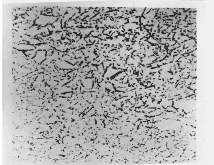
Fig. 8 : SPHEROIDAL DELTA PHASE - ACCEPTABLE
